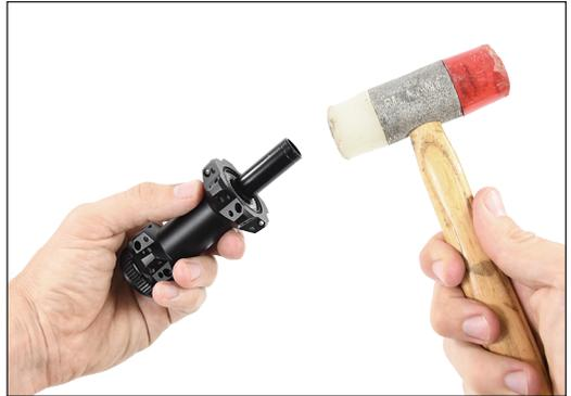
2. Kugellager von der Achse abnehmen.
