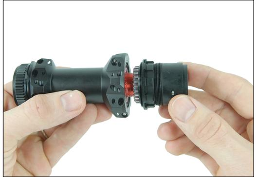
3. Beide Kugellager und Innenseite der Endansschläge mit Universalfett fetten.
