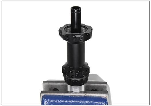
5. Geschraubte Zahnscheibe mit Kugellager auf die Achse aufschieben.
