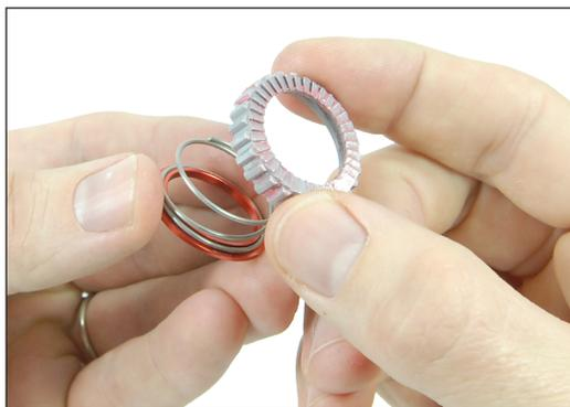
4. Unterlegscheibe, Feder und Zahnscheibe in den Freilaufkörper einschieben.
