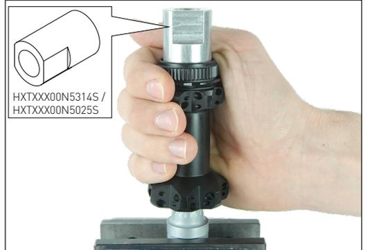
12. Geschraubte Zahnscheibe durch Drehen der Nabe im Uhrzeigersinn so fest wie möglich anziehen.
