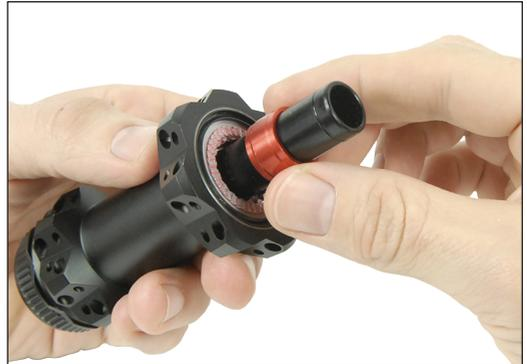
3. Feder auf die Unterlegscheibe stecken und Zahnscheibe auf der Feder anbringen.
