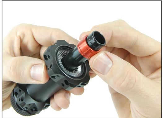
4. Feder, Zahnscheibe und Unterlegscheibe aus dem Freilaufkörper nehmen.
