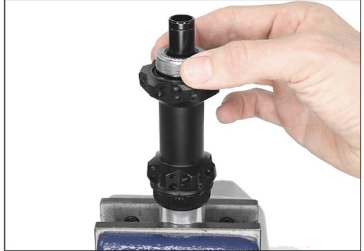
6. Montagewerkzeug in die Verzahnung der Zahnscheibe schieben und Zahnscheibe mit leichtem Druck einige Umdrehungen in das Nabengehäuse einschrauben.
