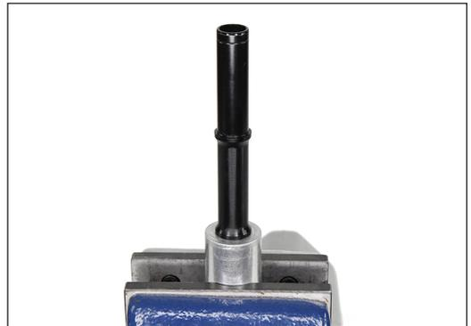
4. Nabengehäuse mit der Antriebsseite nach oben auf die Montagehülse aufstecken.
