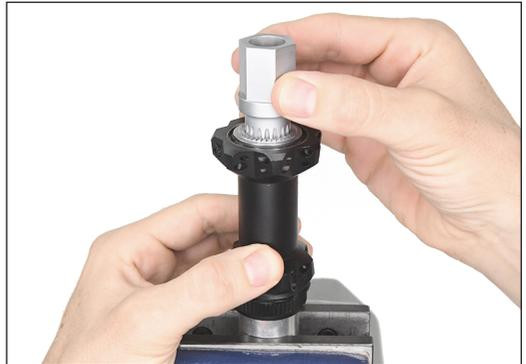
7. Montagewerkzeug abnehmen, Nabe von der Montagehülse abnehmen und Montagehülse aus dem Schraubstock ausspannen.
